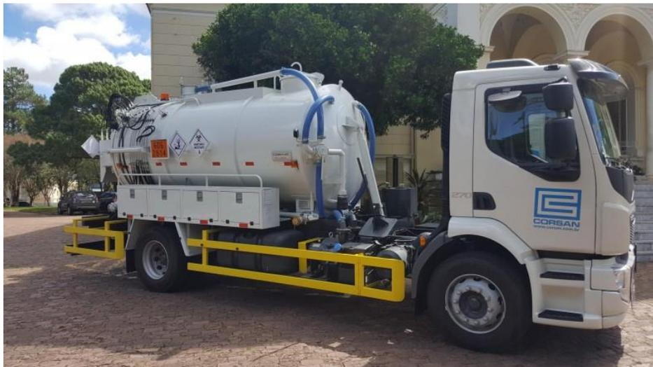
Figura 64: Equipamento para limpeza (remoção) do lodo de fossas sépticas/filtros anaeróbicos.
